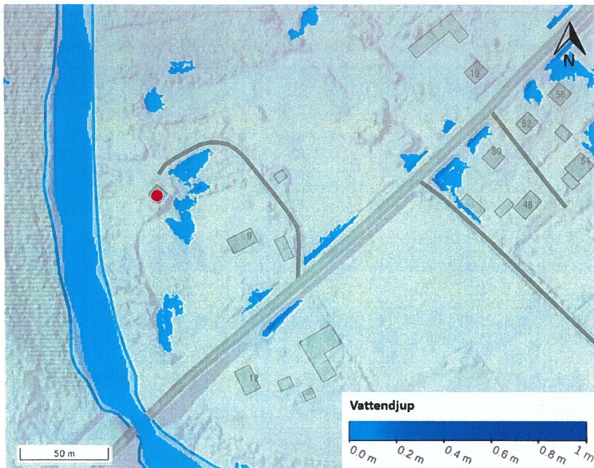
Figur 2. Karta med exempel från skyfallsanalysen i Scalgo Live som redovisar vattennivåer vid Alsåns avloppsreningsverk (röd prick) vid ett skyfall på 106 mm.
