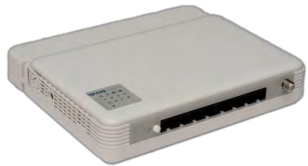
Exempel på fiberkonverter. Bredd: 23 cm, Höjd: 21 cm, Djup: 4,5 cm
